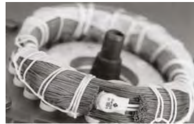
Abb. 42 Thermoschalter - eingebaut in die Wicklungen
