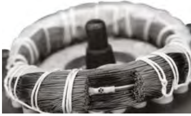
Abb. 40 PTC-Fühler - eingebaut in die Wicklungen
