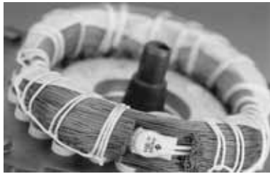
Abb. 22 Thermoschalter - eingebaut in die Wicklungen
