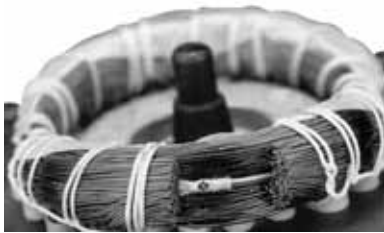
Abb. 20 PTC-Sensor - eingebaut in die Wicklungen
