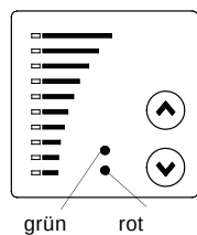
Abb. 60 Anordnung der Meldeleuchten bei einphasigen Pumpen
